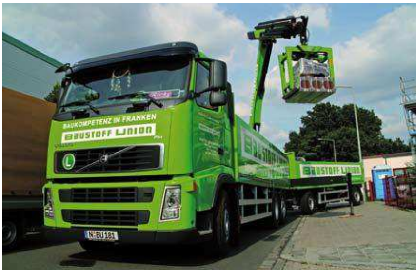
Lieferung mit dem Ziegelzug der BU direkt auf die Baustelle
